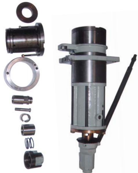
Quick Change Blow Cartridge Assembly N° 118-D-1. Cartucho de Soplado de Cambio Rápido Conjunto N° 118-D-1.
