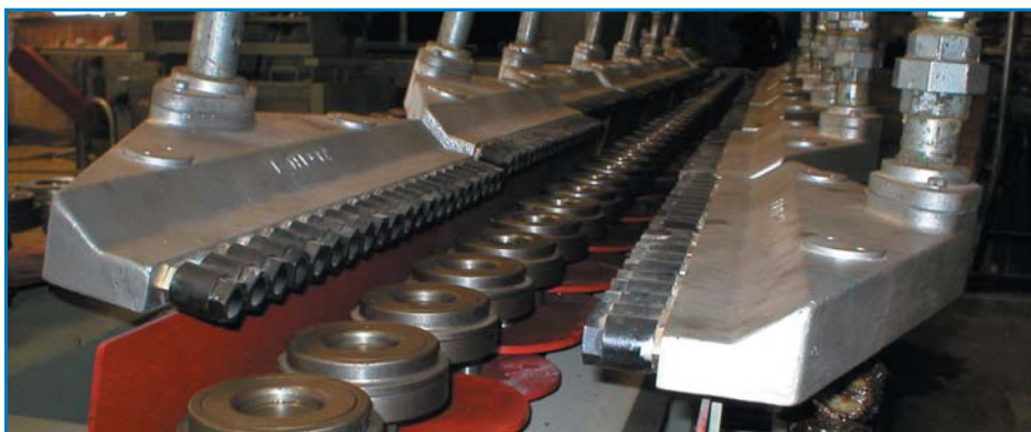
Burners detail / Detalle de quemadores
